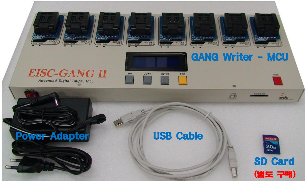
그림 18. GANG Writer 장비(MCU) 및 구성품
