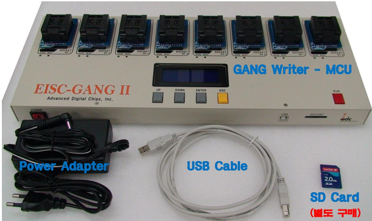
그림 17. GANG Writer 장비(MCU) 및 구성품
