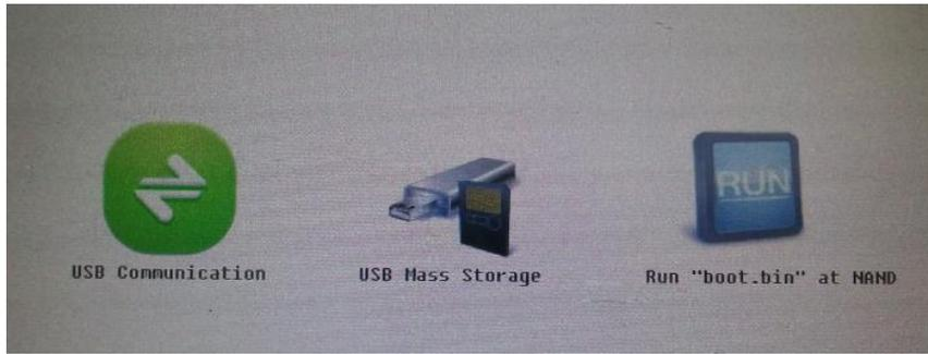
각 아이콘은 각각의 기능을 실행하는데, USB Communication 은 USB device 를 사용하여 application program 을 Dram 에 download 하여 바로 실행해 볼 수 있는 mode 이다. USB Mass Storage 는 개발보드의 NAND Flash 를 컴퓨터상에 USB memory 같이 이동식 디스크로 인식시켜 application 에서 사용할 image 와 sound file 을 복사할 때 사용한다. 마지막으로 Run "boot.bin" at NAND 는 NAND Flash 에 있는 boot.bin 파일의 내용을 Dram 에 복사한 후 실행하는 모드 이다. 각각의 기능에 대한 내용은 3.4 NAND Flash boot 장에서 설명하겠다.
