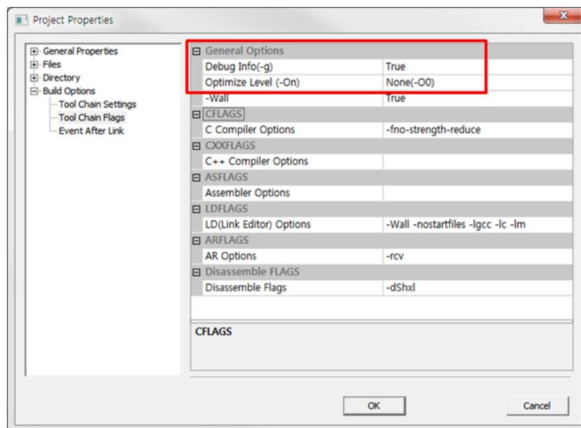
실행하면 위와 같은 창이 뜨게 되고, 빨간 상자 안의 내용, Debug Info(-g)를 TRUE 로 설정하고, Optimize Level(-On)을 None(-O0)로 설정을 한 후 OK 를 누른다. 그런 다음 Build → Rebuild Project 를 실행하여 Rebuild 를 진행한다.
