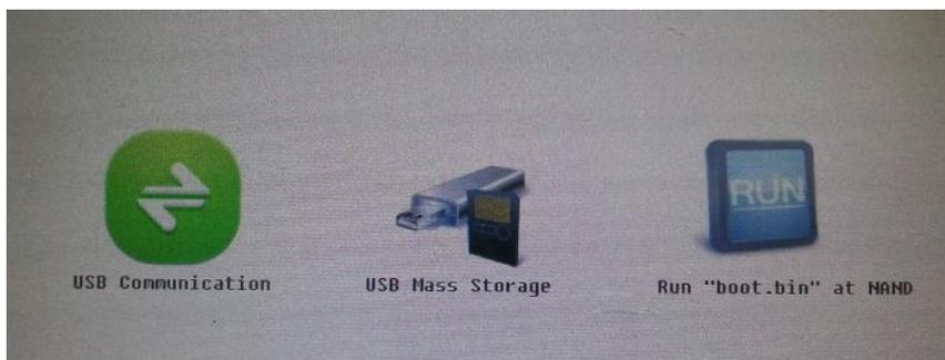
각 아이콘은 각각의 기능을 실행하는데, USB Communication 은 USB device 를 사용하여 application program 을 Dram 에 download 하여 바로 실행해 볼 수 있는 mode 이다. USB Mass Storage 는 개발보드의 NAND Flash 를 컴퓨터상에 USB memory 같이 이동식 디스크로 인식시켜 application 에서 사용할 image 와 sound file 을 복사할 때 사용한다. 마지막으로 Run "boot.bin" at NAND 는 NAND Flash 에 있는 boot.bin 파일의 내용을 Dram 에 복사한 후 실행하는 모드 이다.
