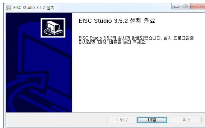
9. EISC Studio 3 설치가 완료 되면 다음으로 Download 장비인 E-Con driver 를 설치하여야 한다. EISC Studio 3 를 설치하면서 E-Con driver 파일을 복사하였다면 E-Con 을 컴퓨터와 연결하여 driver 설치를 진행하면 되고, E-Con driver 파일을 복사 하지 않았을 경우에는 EISC Studio 3 를 설치한 폴더에 econ\driver 라는 폴더 안에 DPInstx86.exe(32bit) 또는 DPInstx64(64bit) 를 실행하여 드라이버 파일을 복사 하고, 설치를 진행하면 된다. 만약 Window 8 이상의 버전을 사용한다면 pc-util 의 Windows8\_64bit\_device\_driver.pdf 파일의 내용대로 진행 한 후 DPInstx64.exe 를 실행해서 설치를 진행하면 된다.
