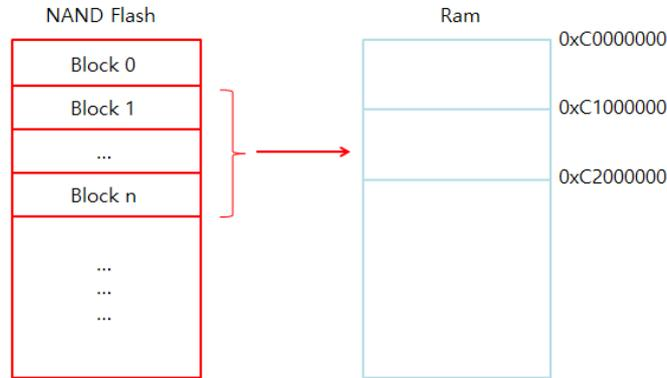
요약하면 NAND Booting 을 하게 되면, NAND Flash 0block 의 2Kbyte 의 NandBootCode 가 내부 SRam 으로 복사되어 실행되고, NandBootCode 에 의해 1block 의 Bootloader 가 Dram 의 0xc1000000 번지로 복사되어 실행을 하게 된다.
